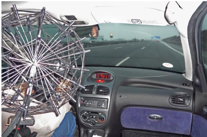
Fig_7. アウトバーン走行中-車室内音響機器設置例
